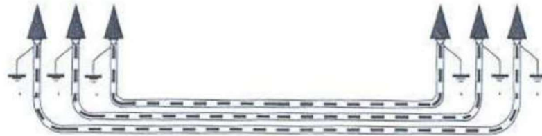
Ilustración 11. Puesta a tierra cubiertas metálicas
