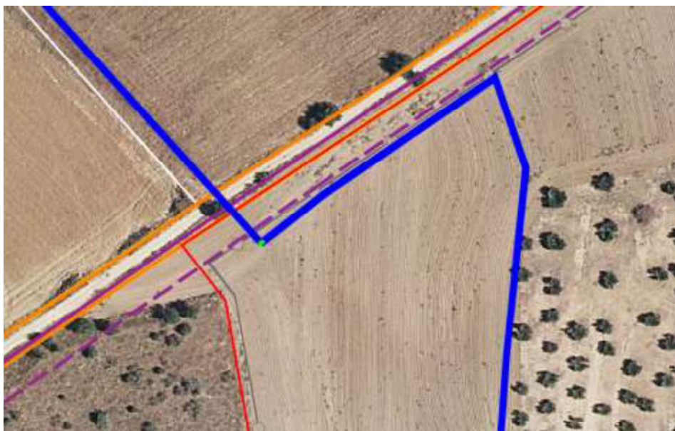
Ilustración 25. Afección gasoducto (1 de 2)
