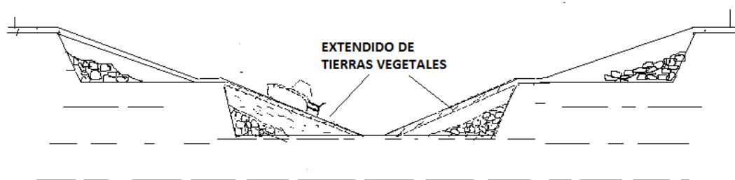
Figura 67. Perfilado de taludes de restauración
