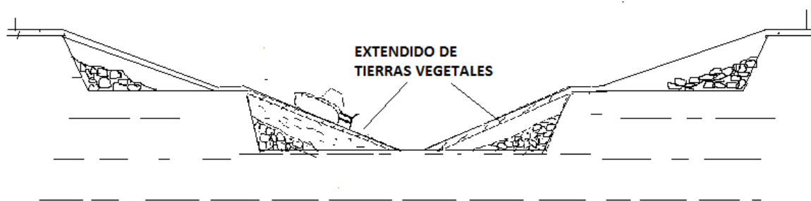
Figura 34. Perfilado de taludes
