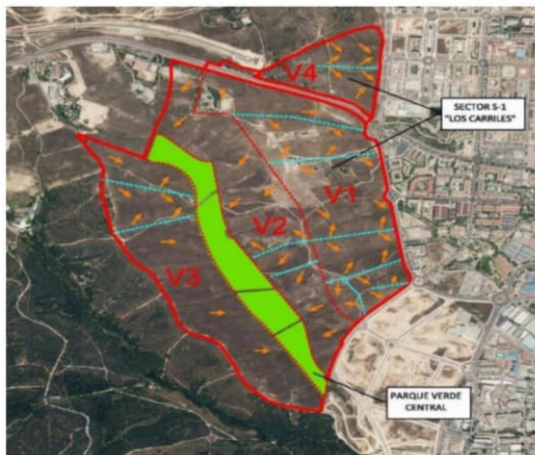
Figura 3: Cuencas vertientes del Sector consideradas para la estimación de las aguas pluviales generadas en su interior (Fuente: Documentación aportada)
