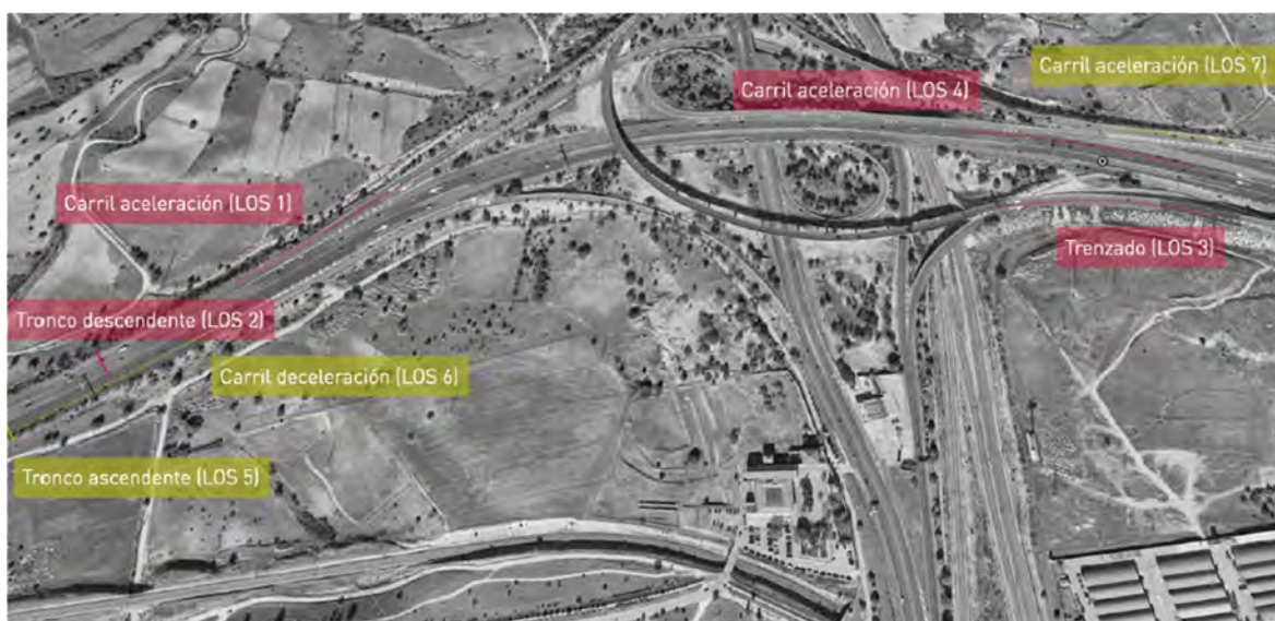
Figura. Puntos en los que se han estudiado los Niveles de Servicio de la M-40
