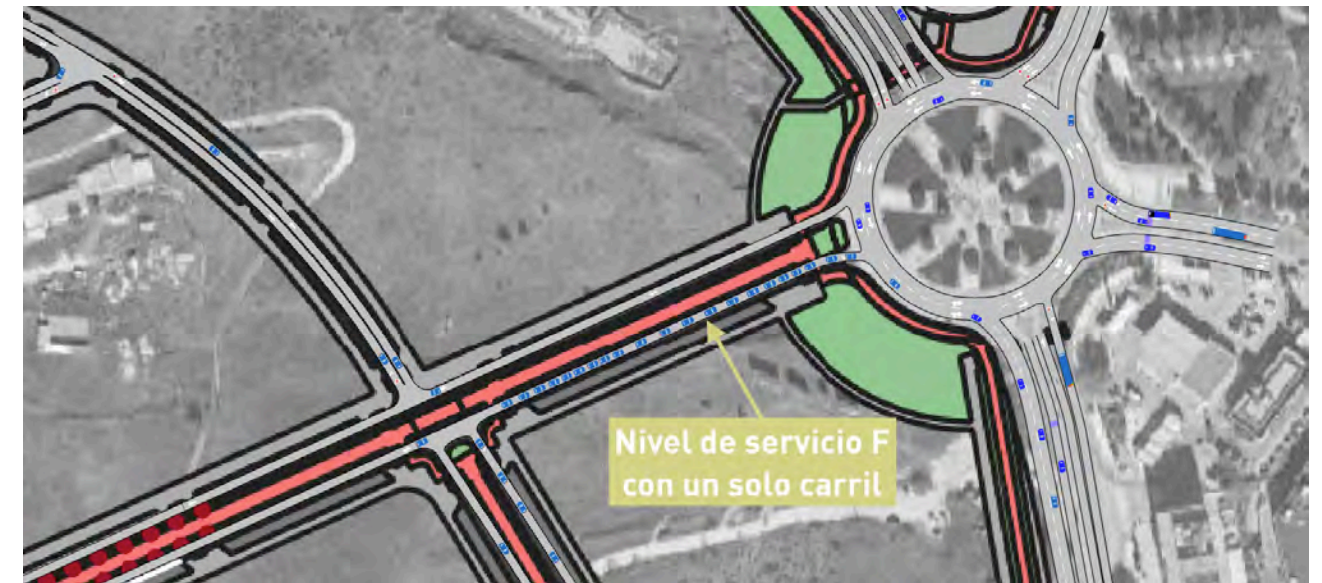
Imagen 60. Nivel de servicio F en el oeste de la CV01.
