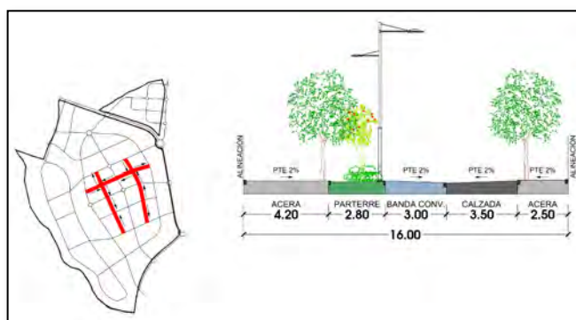
Ilustración 12: Sección tipo para viarios de prioridad peatonal
