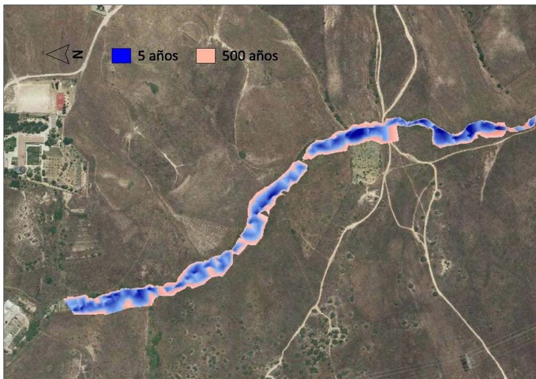
Figura. Detalle del tramo inicial del arroyo para las manchas de inundación en el estado actual para la MCO y el T500
