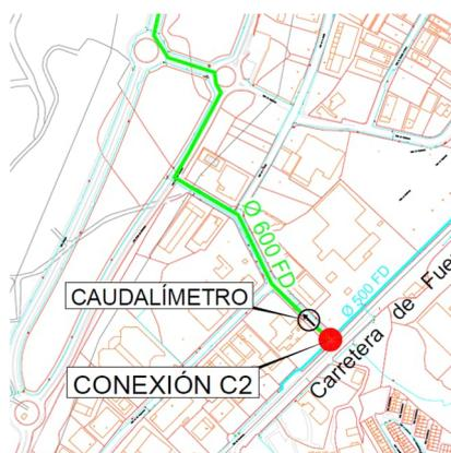
Ambos puntos de conexión quedarán unidos mediante una tubería de  $\varnothing 600\text{mm}$  de fundición dúctil de la que partirá la red de distribución interior del sector, y cuyo trazado discurrirá de norte a sur por viarios o espacios libres públicos no edificables del sector.
