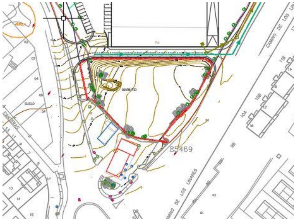
Imagen: Plano de Infraestructuras de la Red de Saneamiento Residual y pluvial. Fuente: Elaboración Propia
