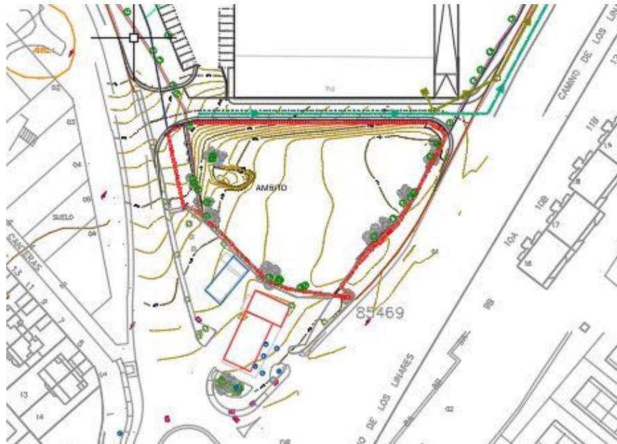
Imagen: Plano de Infraestructuras de la Red de Saneamiento Residual y pluvial. Fuente: Elaboración Propia
