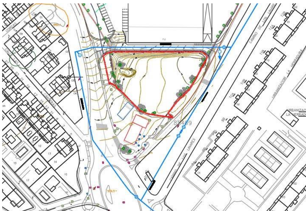
Imagen: Plano de Infraestructuras de la Red de Abastecimiento de Agua Potable. Fuente: Elaboración Propia
