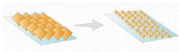
Figura 5. Los paneles fotovoltaicos se aproximan a una geometría simplificada y no se considera el sombreado.
