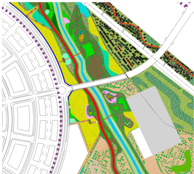
Figura 11. Detalle área del arroyo de los Migueles. Se observa la zona de implantación del estanque de tormentas (en gris) y la traza de la canalización y vía ciclista. El corredor ecológico es atravesado por 3 nuevos puentes, uno de los cuales aparece en esta imagen al norte del estanque de tormentas ya ejecutado.
