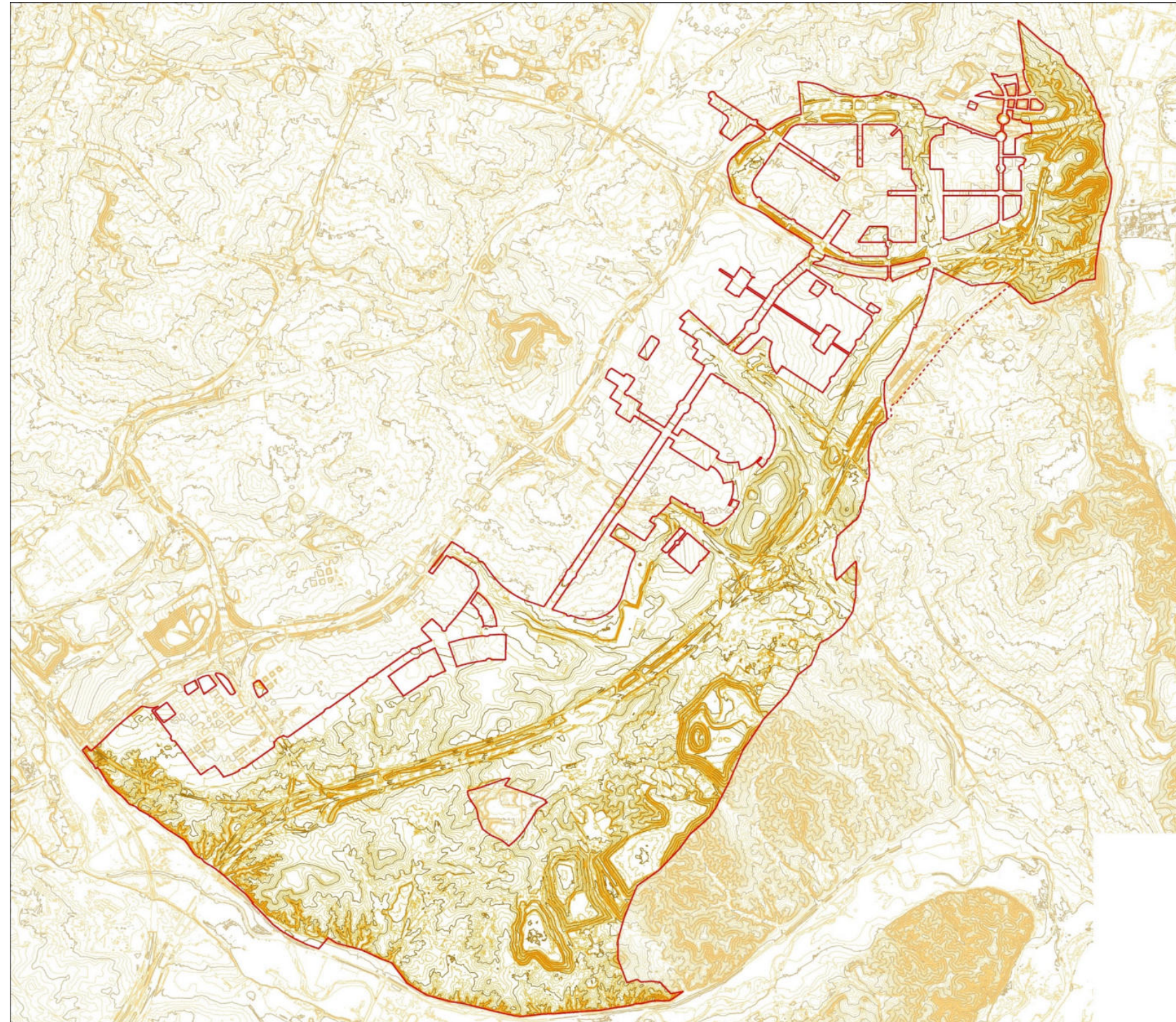
Figura 22. Mapa topográfico de la zona de estudio (curvas cada 2 m y curvas directoras cada 10 m)
