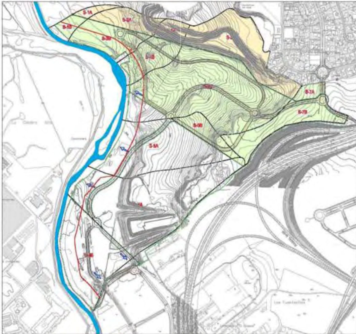
Figura 23. Cuencas generadas en el ámbito del SUP-TO2. (Fuente: Estudio hidrológico e hidráulico, a. cuatro. arquitectos).
