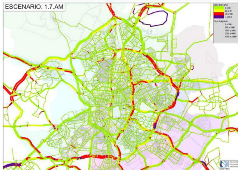
Ilustración 153. Intensidades de tráfico y nivel de saturación (Intensidad/Capacidad) en hora punta de mañana. Escenario 2025. Fuente: elaboración propia
