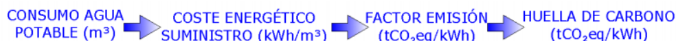
Figura 6.4.2.1. Esquema metodológico para el cálculo de la huella de carbono derivada del consumo de agua potable
