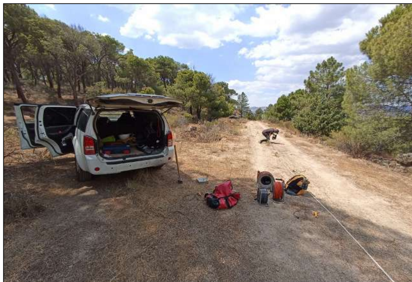
Fotografía 83. Geofísica. Perfiles sísmicos. Sísmica de refracción
