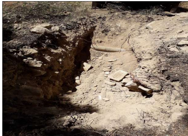
Fotografía 98. Tubería en Calicata 2 (PTO-1)
