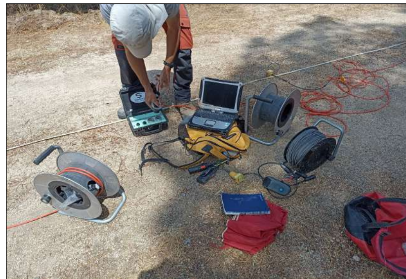
Fotografía 84. Geofísica. Perfiles sísmicos. Sísmica de refracción
