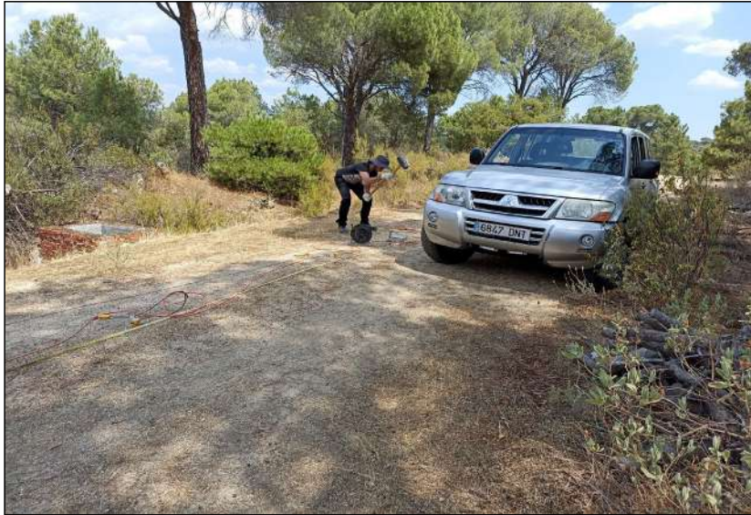
Fotografía 85. Geofísica. Perfiles sísmicos. Sísmica de refracción
