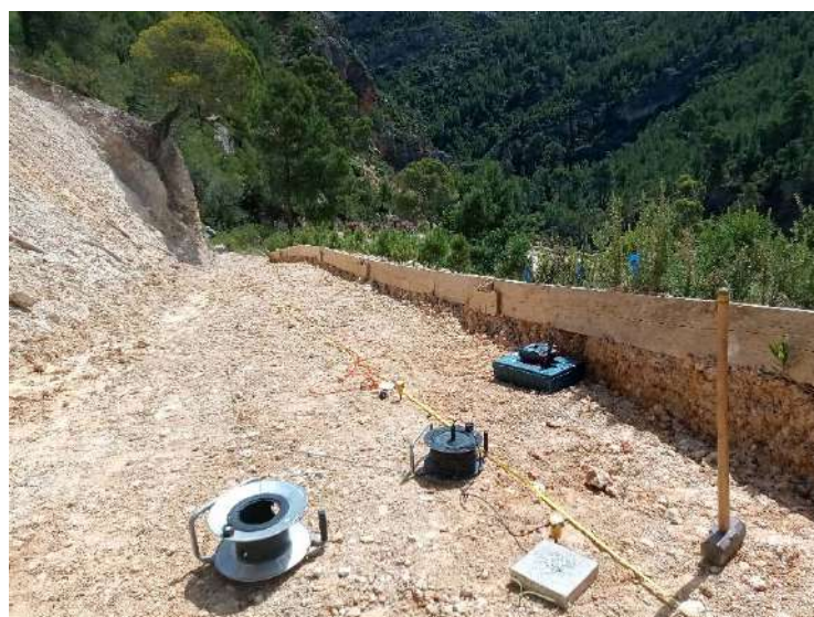
Maza, placa y geófono de trigger.
