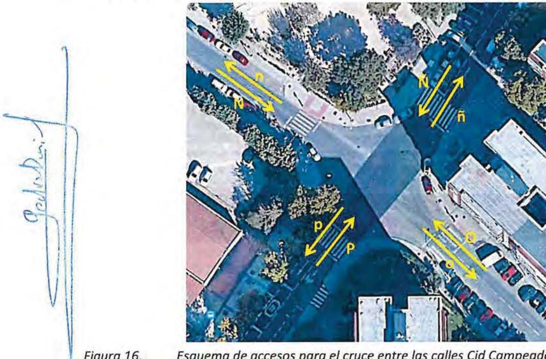
Figura 16. Esquema de accesos para el cruce entre las calles Cid Campeador y Pintor Murillo.
