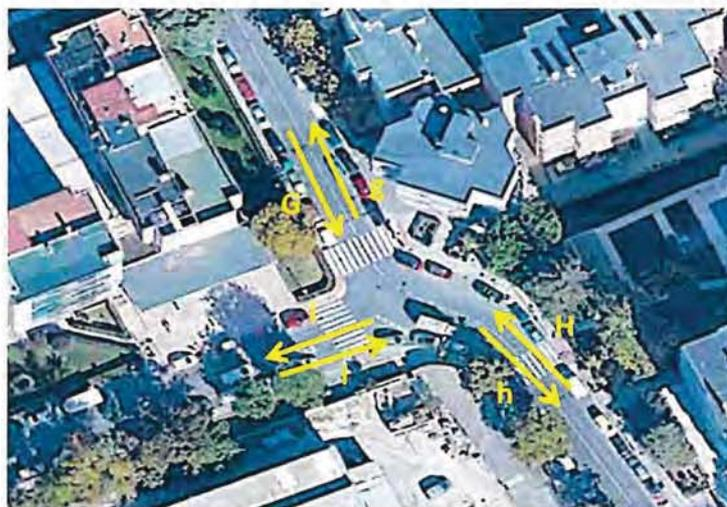
Figura 14. Esquema de accesos para el cruce entre los dos tramos de la calle Rubens.
