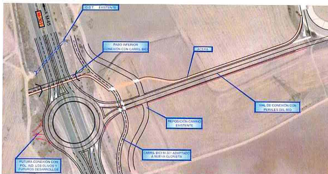
Imagen: Definición de la rotonda: Fuente: proyecto de construcción de nueva conexión en M-301 de la CAM
