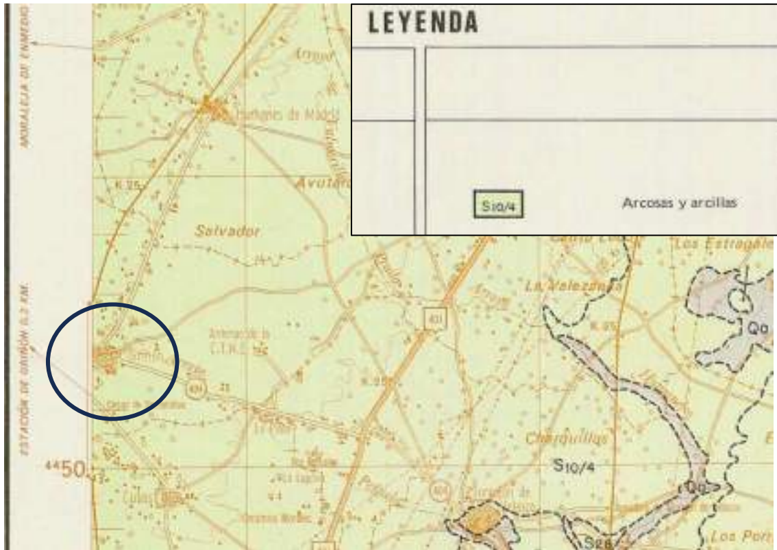
Figura 19: Litología de ámbito de actuación, de acuerdo con sus condiciones constructivas. Fte: Mapa Geotécnico de Ordenación Territorial y Urbana de la Subregión de Madrid. IGME
