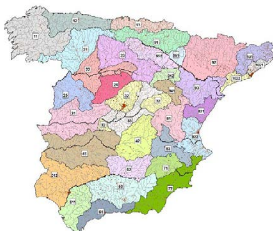
Ilustración 21. Regiones consideradas para la caracterización del coeficiente corrector del umbral de escorrentía
