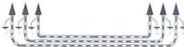
Ilustración 35. Puesta a tierra de cubiertas metálicas
