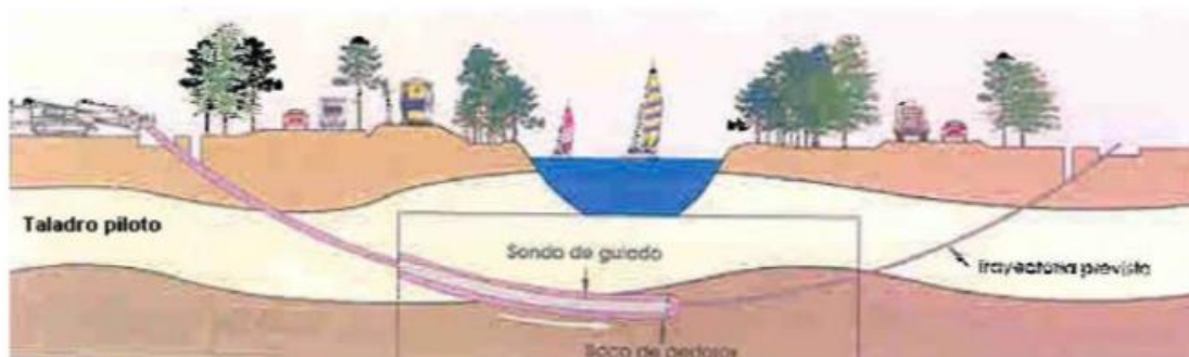
Ilustración 32. Esquema del proceso de perforación piloto.
