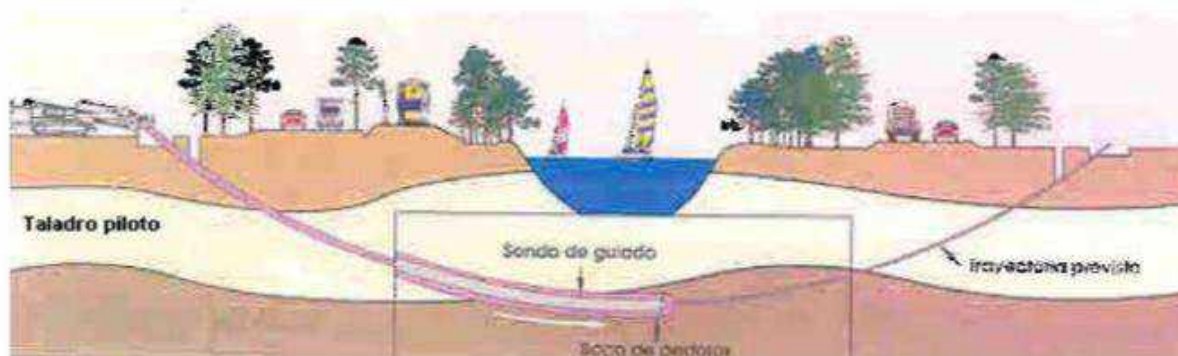
Ilustración 26. Esquema del proceso de perforación piloto
