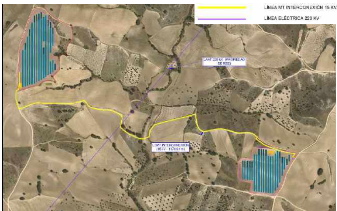
Ilustración 7. Línea eléctrica aérea existente. AfECCIÓN a islas de la Planta
