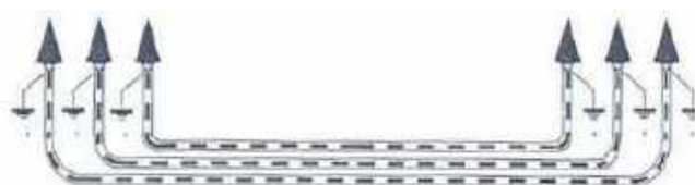
Ilustración 31. Puesta a tierra de cubiertas metálicas
