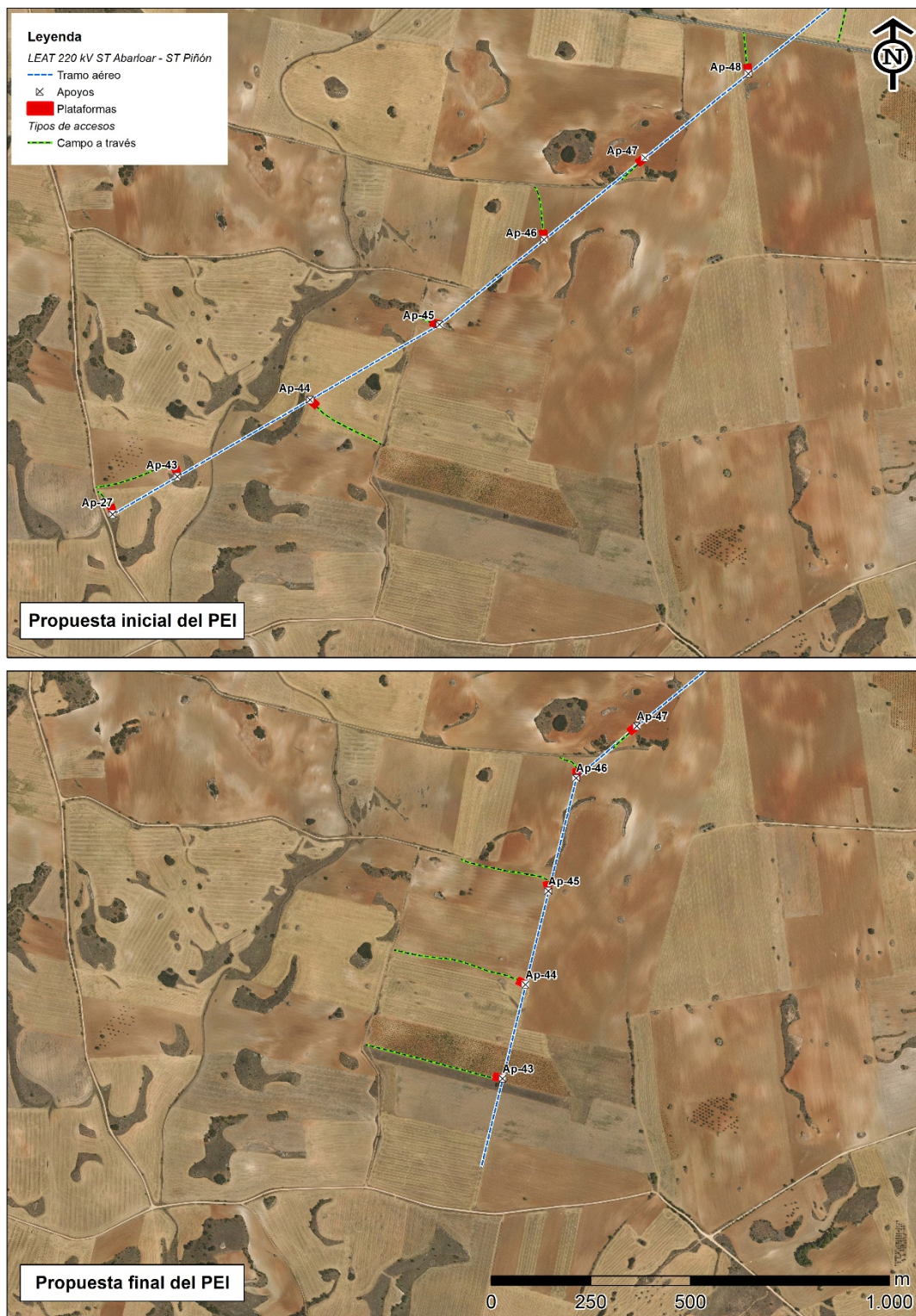
Figura 14. Comparación entre la propuesta inicial y la propuesta final de la LEAT en cuanto a la ocupación del suelo por parte de los apoyos. Fuente: elaboración propia.
