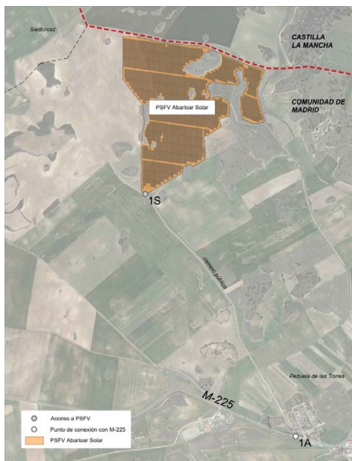
Figura 6. Situación de los puntos de conexión de los caminos de acceso a la planta con la carretera autonómica M-225. Fuente: RH Estudio.
