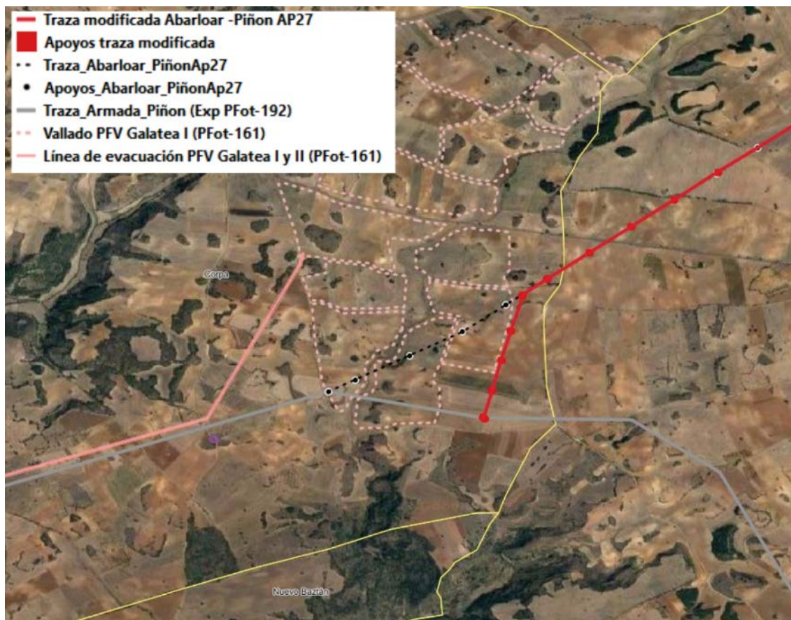
Figura 11. Comparación entre la propuesta inicial y la propuesta final de la LEAT objeto del PEI, junto con la implantación de la PFV Galatea I. Fuente: IGNIS.
