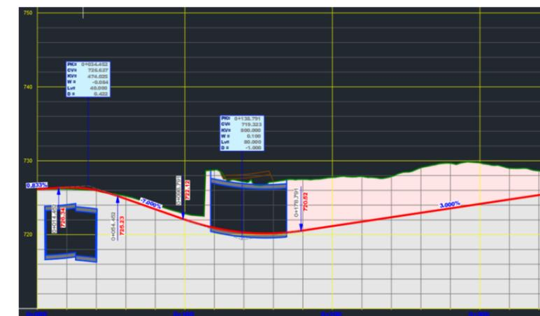
Imagen 60: Perfil longitudinal de Ramal de Alcobendas M-603 a Madrid Nuevo Norte
