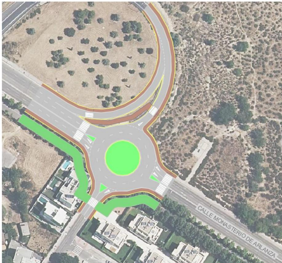
Imagen 8. Vista general de la alternativa GM-1 en calle Monasterio de Arlanza mediante glorieta centrada.
