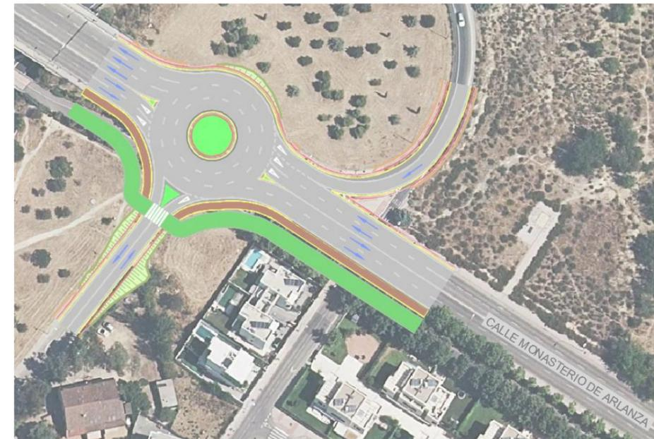
Imagen 9. Vista general de la alternativa GM-2 en calle Monasterio de Arlanza mediante glorieta descentrada.
