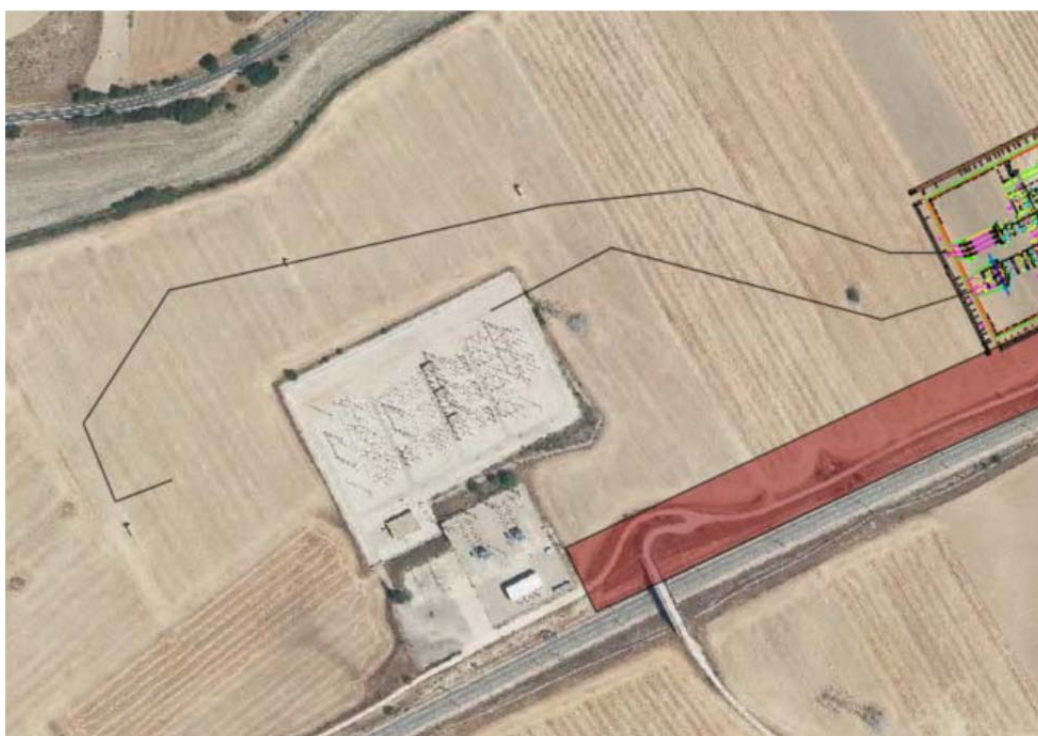
Propuesta indicativa de trazado de las LAAT modificando implantación de la SET Henares hacia el sur
