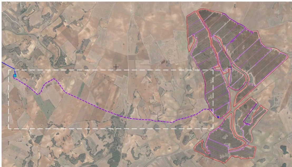
Línea externa de evacuación de la PSFV Maladeta Solar en 30 kV
