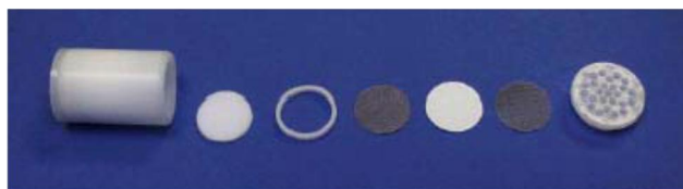
Figura 2. Elementos del captador pasivo Ogawa. (Fuente: Manual Radiello).
