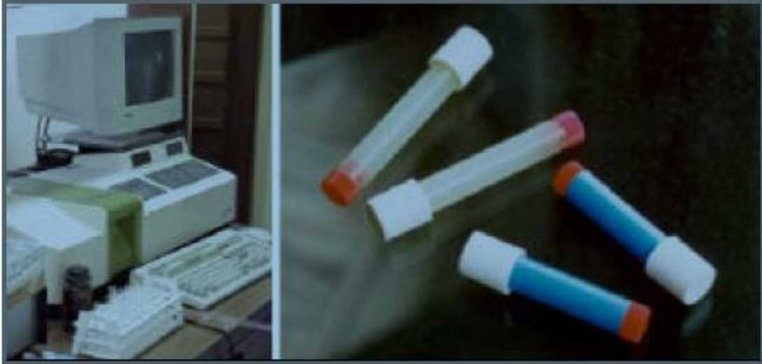
Figura 4. Espectrofotómetro utilizado para el análisis de tubos y ejemplos de tubos captadores ( \text{NO}_2 los dos de arriba –blancos- y \text{O}_3 los dos de abajo –azules-). (Fuente: Manual Radiello).
