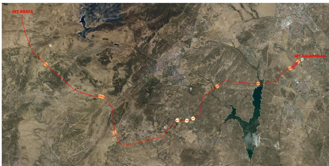
Imagen 13: Cruces de líneas eléctricas existentes a lo largo de la LAAT. Elaboración propia.
