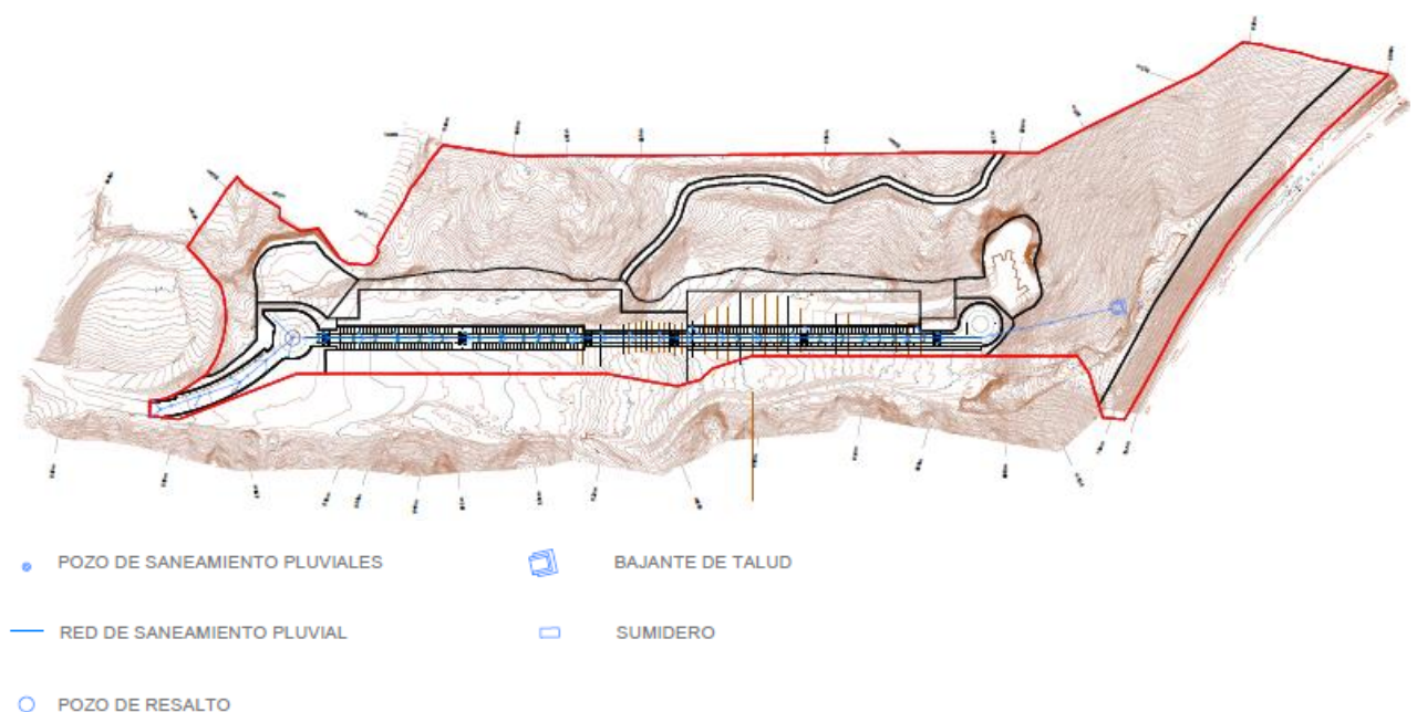
Red de saneamiento: Aguas Pluviales Sector 11
