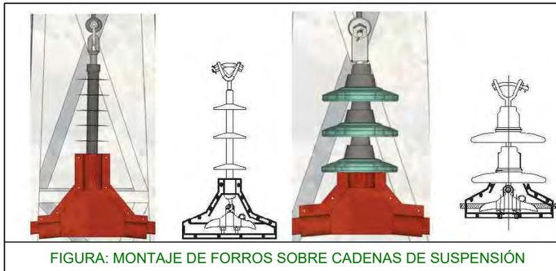
FIGURA: MONTAJE DE FORROS SOBRE CADENAS DE SUSPENSIÓN
