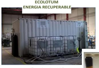
Prototipo de 50 L/h Solubilización completa de sólidos Eliminación de patógenos
