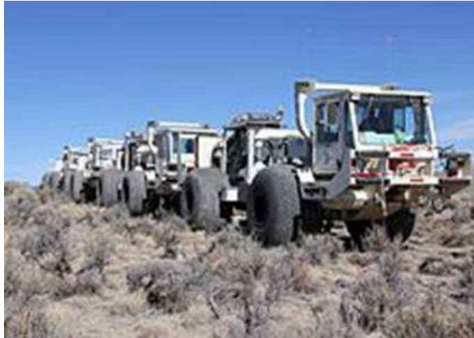
Figura 8. Diferentes vehículos utilizados en la adquisición de sísmica de reflexión en tierra.
