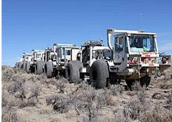
Figura 13. Diferentes vehículos utilizados en la adquisición de sismica de reflexión en tierra.
