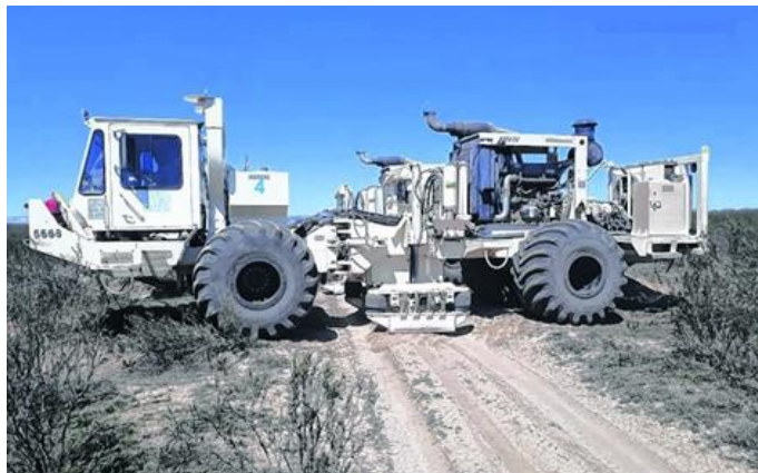
Figura 13. Diferentes vehículos utilizados en la adquisición de sismica de reflexión en tierra.
