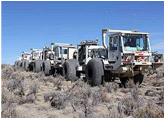
Figura 4. Diferentes vehículos utilizados en la adquisición de sísmica de reflexión en tierra.
