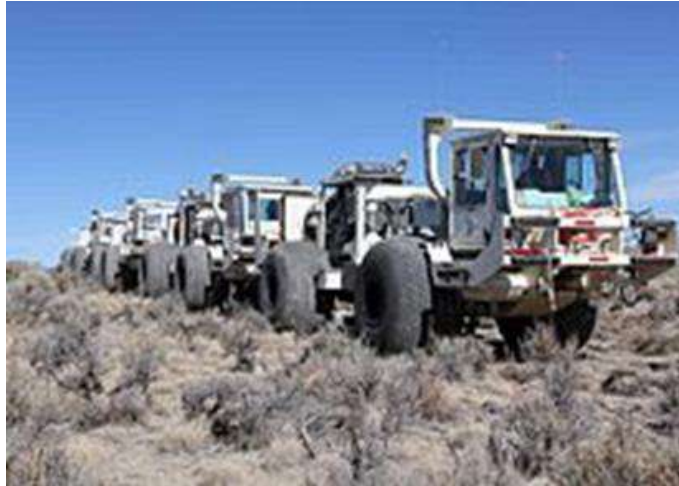
Figura 10. Diferentes vehículos utilizados en la adquisición de sísmica de reflexión en tierra.
