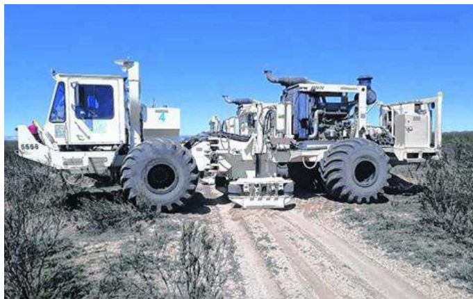
Figura 5. Diferentes vehículos utilizados en la adquisición de sísmica de reflexión en tierra.
