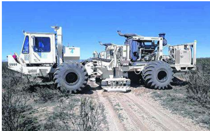
Figura 10. Diferentes vehículos utilizados en la adquisición de sísmica de reflexión en tierra.
