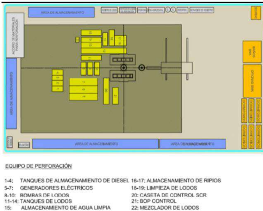
Figura 14. Esquema con los principales elementos a la plataforma de perforación
