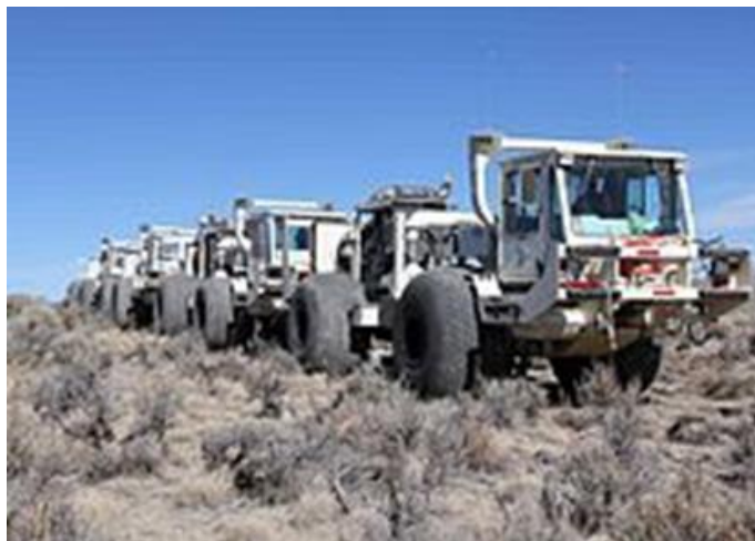
Figura 11. Diferentes vehículos utilizados en la adquisición de sismica de reflexión en tierra.
