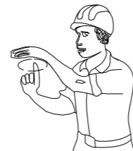
11 GIRAR EL AGUILON EN LA DIRECCION INDICADA POR EL DEDO
