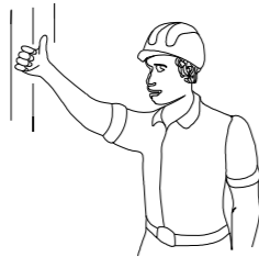
10 BAJAR EL AGUILON O PLUMA Y LEVANTAR LA CARGA
