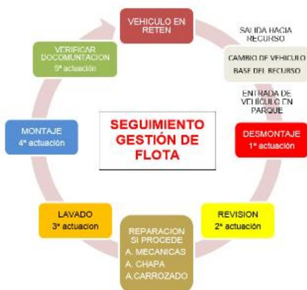
Proceso de rotación programada de los vehículos asignados a cada recurso con el fin de realizar el control y mantenimiento preventivo y correctivo de la flota del SUMMA 112 con el objetivo de que las unidades asistenciales dispongan de los vehículos, junto con su equipamiento electro medico en estado óptimo para la prestación del servicio.
