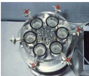
Foto 4. Testador de fatiga. Cámara de fatiga que permite estudiar prótesis con ciclos veinte veces superiores al fisiológicos y paralizar la imagen por medio de una luz estroboscópica.
