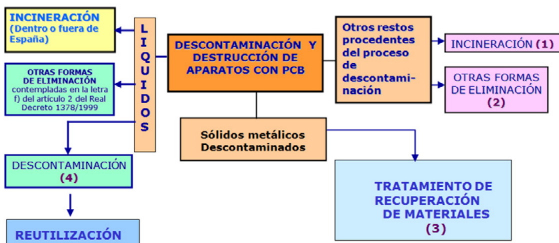
Figura 1. Proceso de tratamiento de aparatos con PCB
