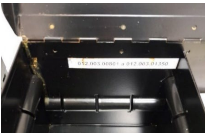
Cajón afectado por el óxido en sus bisagras, pared posterior y etiquetas de identificación.
