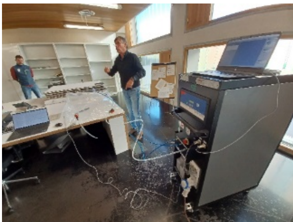
Demostración del funcionamiento de un equipo de anoxia por nitrógeno
