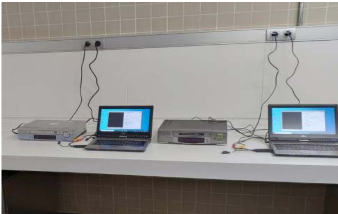
Instalación de equipos en el Taller de Digitalización de la Subdirección General de Archivos y Gestión Documental para la conversión digital de cintas de vídeo en formato VHS.
